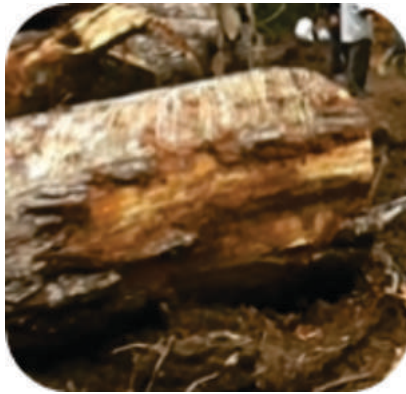
Gambar 3. Kayu dengan Cacat Gubal Busuk
