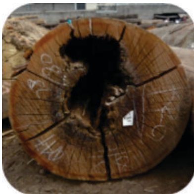
Gambar 4. Kayu dengan Cacat Gubal Busuk
